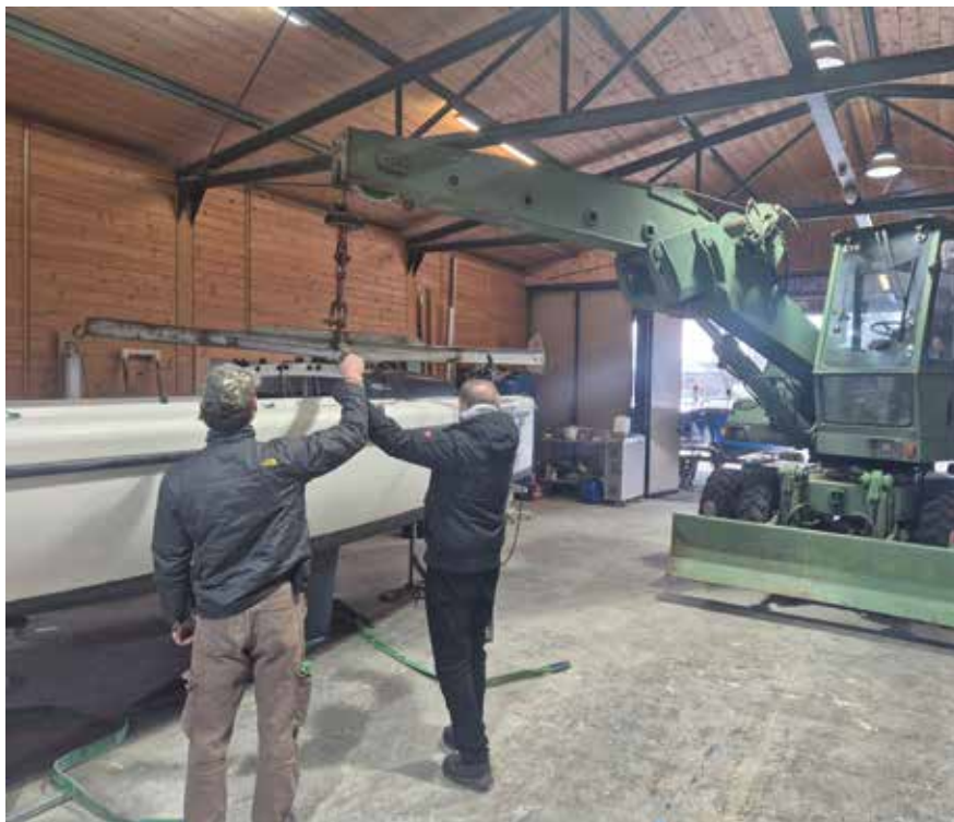
Die Airas werden mit dem Kran aus der Bootshalle gehoben
