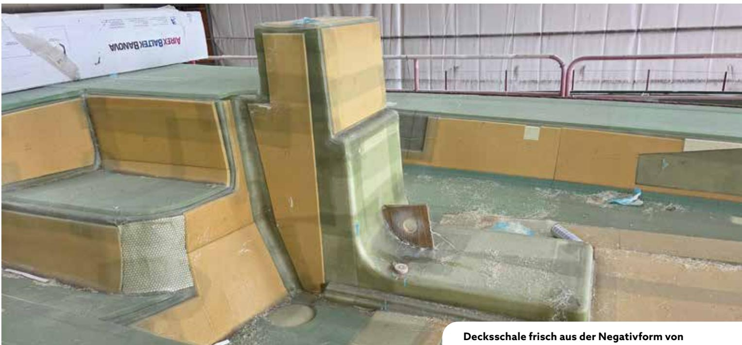
Decksschale frisch aus der Negativform von Baunummer 10, bevor der Himmel montiert wird
