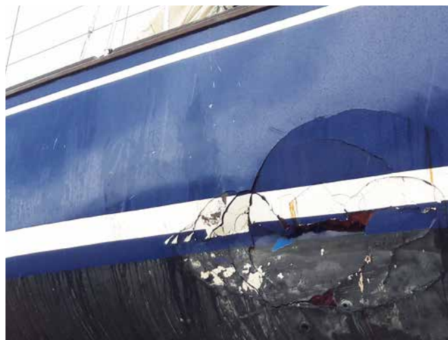
Riss im Rumpf und abgerissener Skeg
